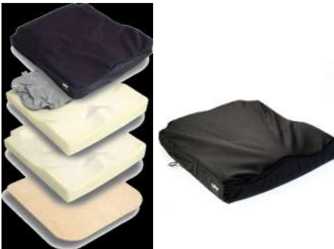
Figura 20. Almofada JAY Easy : Almofada desenvolvida para usuários requerem estabilidade postural e alívio de pressão. Ela é confeccionada com a combinação de materiais (poliuretano e fluido), além de apresentar um desenho anatômico: a parte posterior da almofada apresenta um corte diferenciado na região da pélvis e do cóccix , oferecendo espaço para encaixe melhor essa região e fornece contornos significativos na região lateral e medial da coxa. A bolsa com fluido (gel elastômero) situada na região de maior risco de UP – região sacral e dos ísquios, proporciona alívio de pressão e redução do cisalhamento. O design desta almofada permite que ela possa ser usada em base de assentos em tecido (é acompanhada de base rígida de madeira), ou planas. (Figuras gentilmente cedidas pela LOH Medical Brasil)
