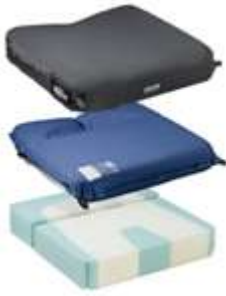
Figura 7. Varilite Meridian , esta almofada é composta por uma base confeccionada utilizando vários tipos de espuma e uma bolsa de ar compartimentada em 3 colocada por cima dessa base de espuma. A base de espumas utiliza três tipos de espuma: espuma macia para a área das tuberosidades isquiáticas; espuma de dureza média para a calha da coxa, encaixe pélvico e bar pré-isquiática, e espuma firme para o perímetro e separado medial da coxa (abdutor). Terapeutas recomendam o Meridian para indivíduos com disfunções motoras e neurológicas devido a uma lesão da medula espinhal, acidente vascular cerebral, esclerose múltipla, paralisia cerebral e traumatismo crânio-encefálico. Terapeutas valorizam o cume pré-isquiática integral e efeito cunha criado por duas câmaras do Meridian. (Figura retirada do sítio eletrônico da Varilite em 11/08/2013)
