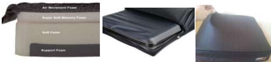
Figura 8 . Almofada Jay Ion: Esta almofada oferece três recursos de última tecnologia na fabricação de almofadas: tecido elástico antimicrobiano, camadas de vários tipo de espuma com diferentes características (descrição de cima para baixo: “Air movement foam” permitindo a circulação do ar e criando boas condições para o microclima próximo a superfície do corpo do usuário; espuma viscoelástica, espuma macia e espuma mais dura para suporte), e capa impermeável. O tecido fino utilizado torna a lavagem e a secagem da capa um processo fácil. A parte impermeável da capa que fica no seu interior pode ser facilmente retirada. A capa externa da almofada é antimicrobiana, pois o tecido é impregnado com prata. Estudos mostram que a prata inibe o crescimento bacteriano. Por fora, parece um exemplo simples de almofada que previne o aparecimento de UP, mas por dentro, é uma verdadeira combinação de alta tecnologia. (Figuras gentilmente cedidas pela LOH Medical Brasil).
