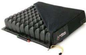
Figura 11. Almofada ROHO QS1010C: almofada de ar com membrana impermeável cujo compartimento do recipiente – células intercomunicáveis - faz aumentar a estabilidade do usuário comparada a uma que tivesse recipiente único para o ar. Distribui bem a pressão, tem bom envolvimento, pouco atrito e cisalhamento. Não é indicada para usuários que tenham assimetria ou instabilidade postural. (Figura retirada do sítio eletrônico da ROHO em 11/08/2013)
