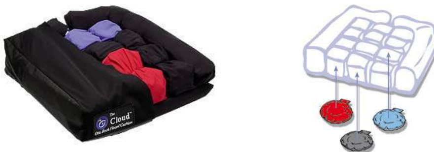
Figura 6 . Almofada Otto Bock “Cloud”:Almofada idealizada para usuários de cadeira de rodas que necessitam posicionamento ideal, estabilidade e alívio máximo de pressão. Ela é composta por uma base de espuma, em cima dessa base o assento é dividido em 14 células de espuma fluida (“foam”), com capacidade de suporte diferentes (cada cor representa essa capacidade de suporte diferente), distribuídas anatomicamente de acordo com as necessidades de suportes de cada região das nádegas e coxas do usuário. Essa combinação de elementos aumenta a superfície de contato (envolvimento), distribuindo efetivamente a pressão em todo o segmento corporal reduzindo a pressão nas zonas de maior risco e evitando o cisalhamento. As células da região posterior e laterais proporcionam apoio adicional para o posicionamento. Como as células de espuma fluida podem ser facilmente trocadas , esta almofada permite acomodações e ou correções de obliquidades pélvicas, antro- e retroversão pélvica. (Figuras gentilmente cedidas pela Ottobock Brasil, 2013).
